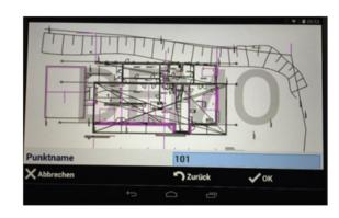
Nun werden Sie nach der Punktnummer des zu erzeugenden Punktes gefragt. Hier können Sie eine beliebige Punktnummer angeben. Bestätigen Sie dies anschließend mit "OK".
